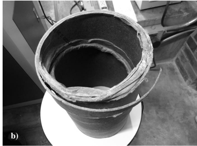
Figura 6. Cuerpo de prueba después del ensayo: a) Superposición de fibras en el exterior del tubo de ensayo; b) superposición de fibras en el interior
