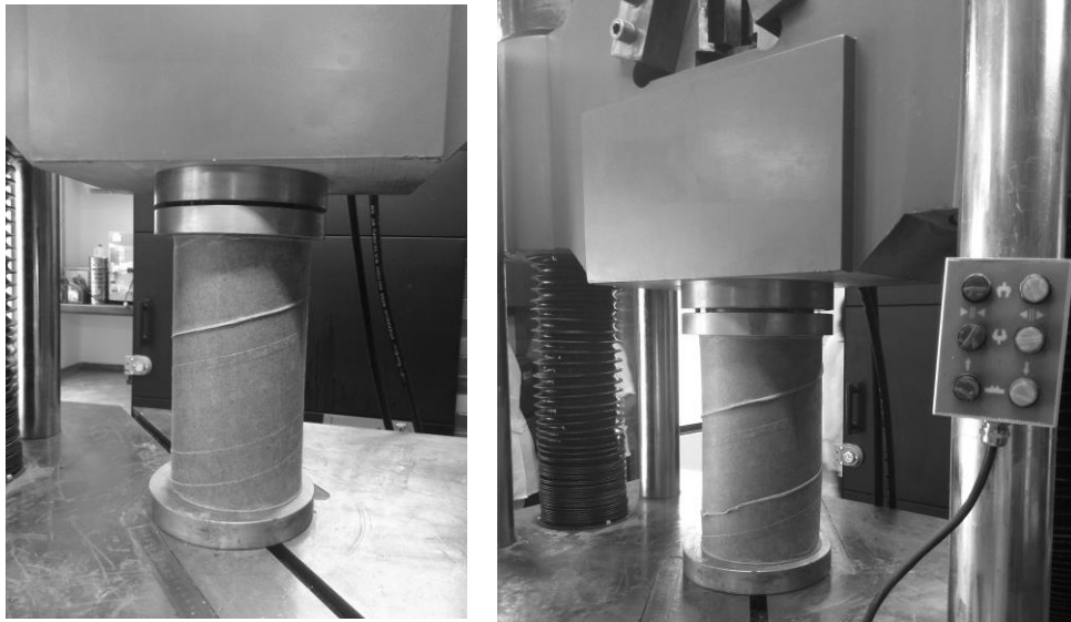
Figura 8. Cuerpo de prueba después del ensayo
