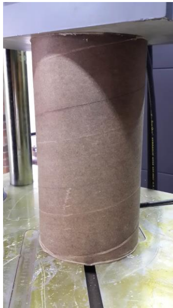
Figura 11. Deformación de la muestra M3, al finalizar el ensayo de compresión axial.
